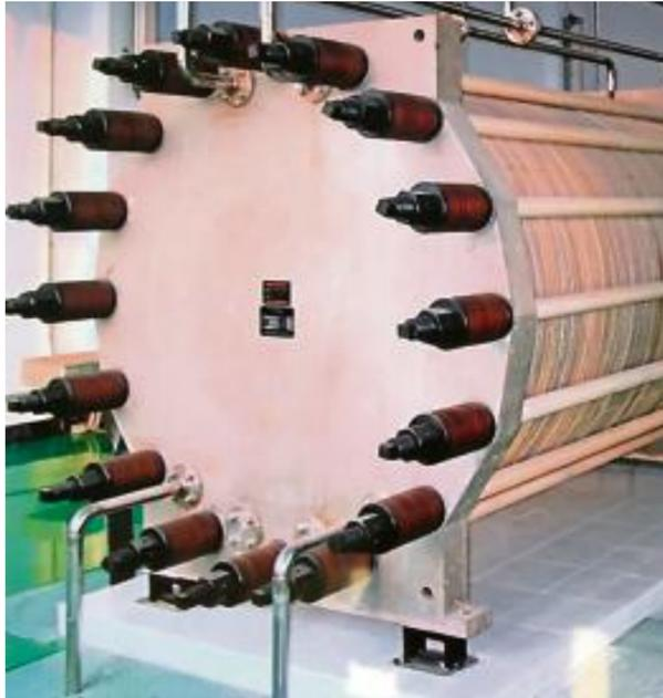
Un électrolyseur de production d'hydrogène. Photo HydrogenPro
